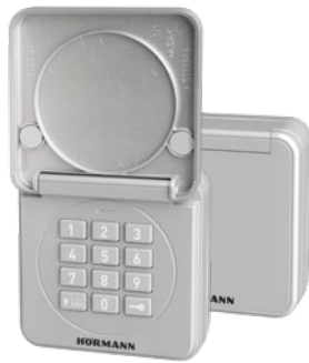
Trådløst kodetastatur FCT 10 BS 10 funktioner, med belyste knapper og klapdæksel, indbygning i og på væg muligt, kunststofkabinet lakeret i hvidaluminium RAL 9006
