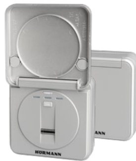
Trådløs fingerscanner FFL 25 BS Til 2 funktioner, op til 25 fingeraftryk, med klapdæksel. Indbygning i og på væg muligt, kunststofkabinet lakeret i hvidaluminium RAL 9006
