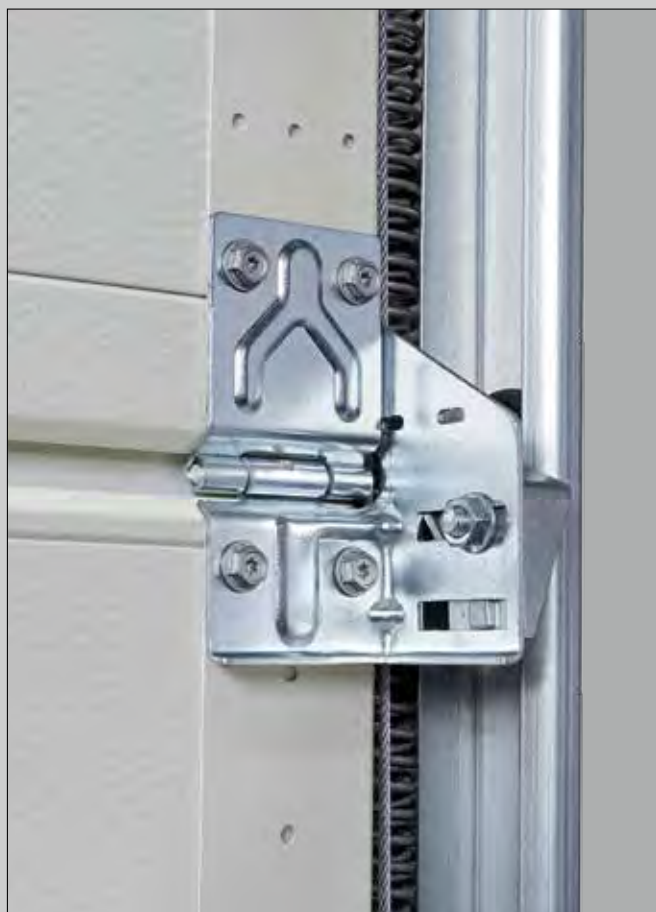
Standardudførelse (fig. LPU 67 Thermo) Galvaniserede beslag, karm, køreskinner og forbindelsesskinne
